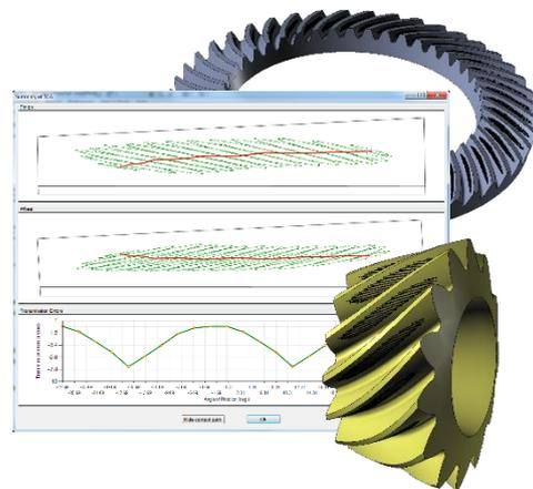
IGD implementa un módulo para el diseño topológico libre de las superficies de contacto de los engranajes, permitiendo incorporar modificaciones microgeométricas para que el usuario pueda evaluar el comportamiento mecánico de la transmisión. Las modificaciones también pueden provenir de los datos de medida de una máquina de medición por coordenadas, convirtiendo a este módulo en una herramienta importante para el diagnóstico de transmisiones de engranajes ya fabricadas.
